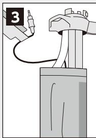
チューブカバーの中を通し、適切な長さになるように調節します。
