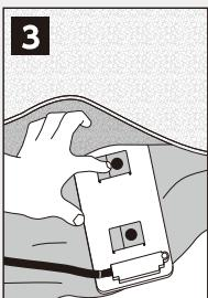
ヘッドアップセンサの固定ベルト(2ヵ所)を外し、センサを引き抜いていきます。
