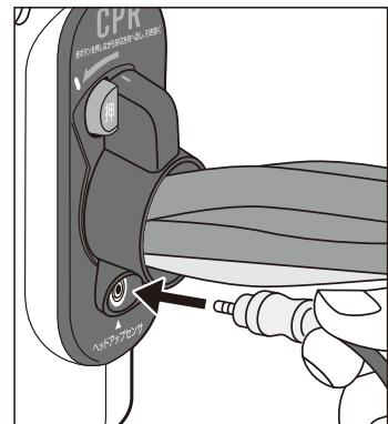
ヘッドアップセンサの青いプラグをヘッドアップセンサ接続口に差し込みます。
