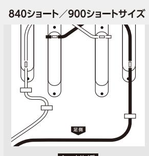
スマールチェンジ用送風チューブ(白)は、2ヵ所、スマールチェンジ用送風チューブ(黒)は、1ヵ所のベルトを通してください。
