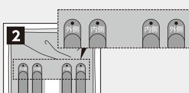
1マットレスの底面のファスナーを開けます。2スマールチェンジ用エアセルの刻印(内側/外側)が頭側になるようにホックで固定します。
