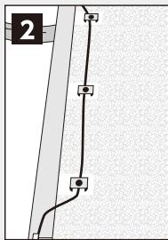
ベースマット固定用ベルト(3ヵ所)にコードを通します。コードは送風チューブ口から引き出します。
